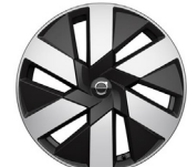
19 吋 6 輻 黑鑽石切割鋁合金鋼圈 Black Diamond Cut 235 / 40 R19
